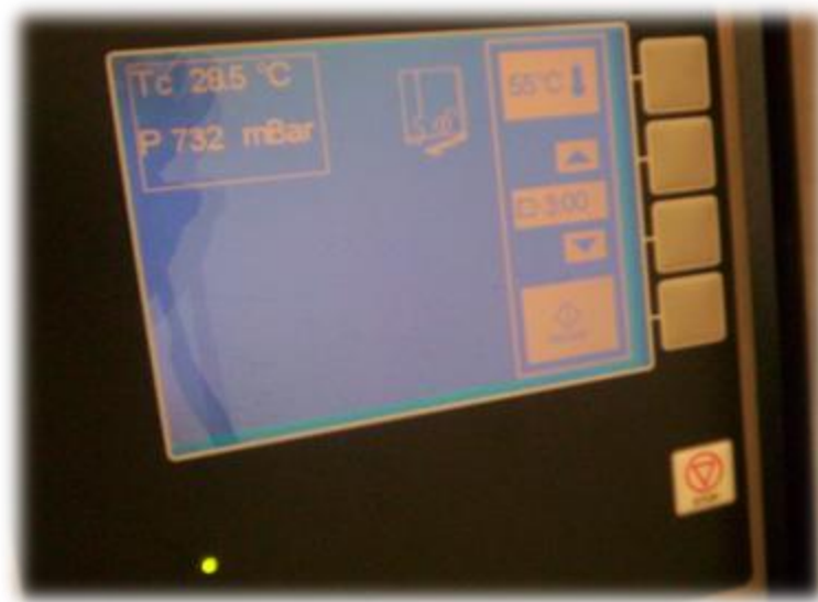
Fig. 1.- Indicadores físicos visibles de un esterilizador: registra temperatura, presión y sistemas de registro
